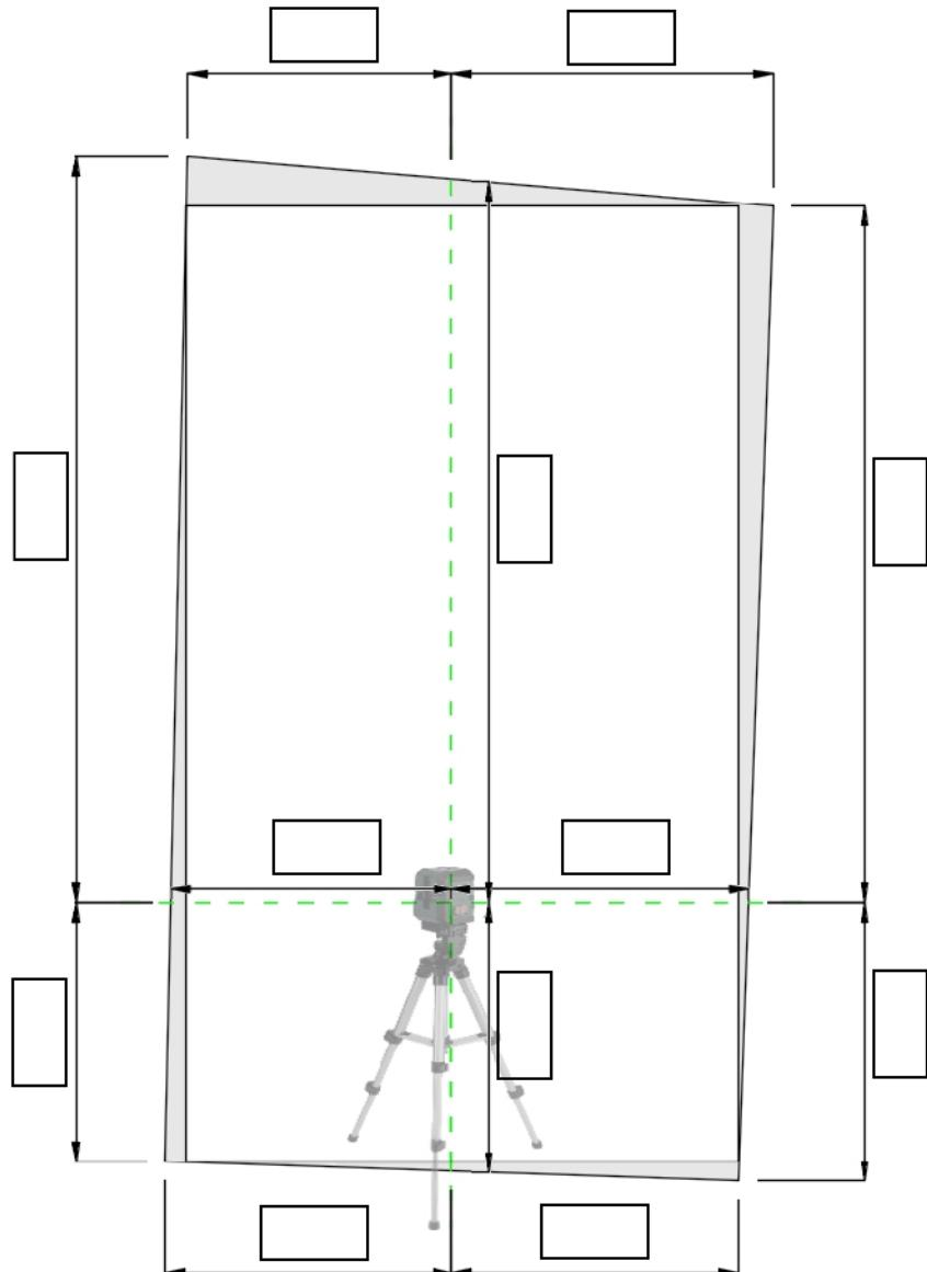
Mit einem Kreuzlinienlaser von den lotrechten Linien ausgehend die Maße abnehmen (wie oben dargestellt) damit man die Unebenheiten der Raumlichte erkennen und dementsprechend die Anlage planen kann!
