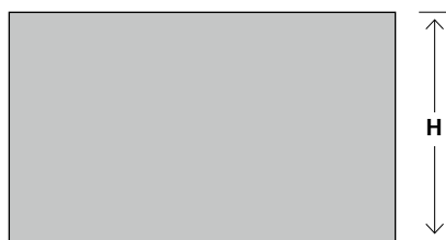
Abb. 1 liegendes Rechteckformat, für Drehtüren ungünstig Größenverhältnis max. (H:B) 1:1,25
