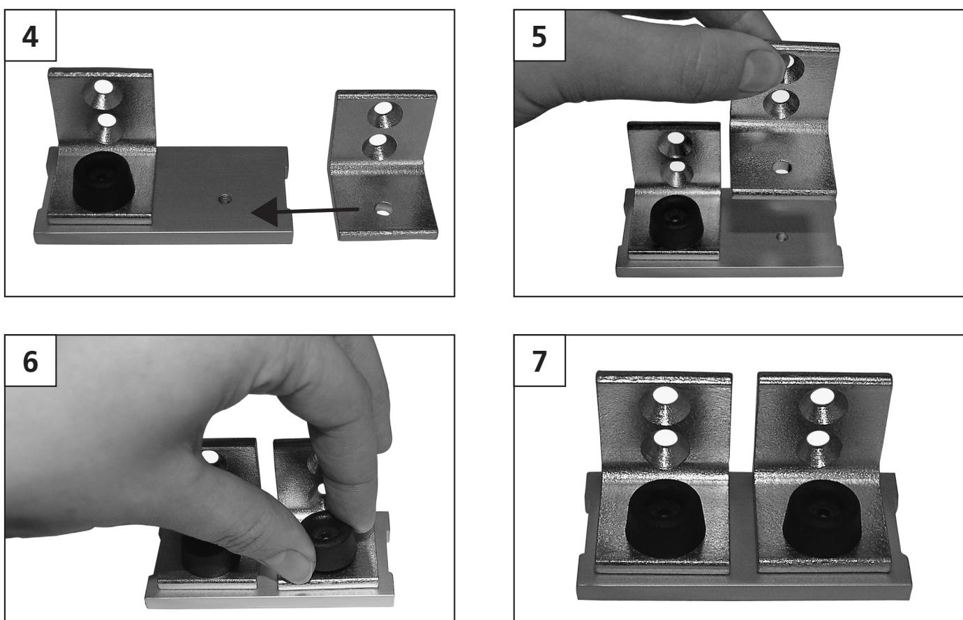
Wenn Sie eine Blende einsetzen wollen, dann müssen Sie einen schwarzen Gummistopper (siehe Bild) verwenden: Stellen Sie den Winkel auf die Blende an die dafür vorgesehene Position und befestigen ihn mit dem schwarzen Gummistopper an der Blende.
